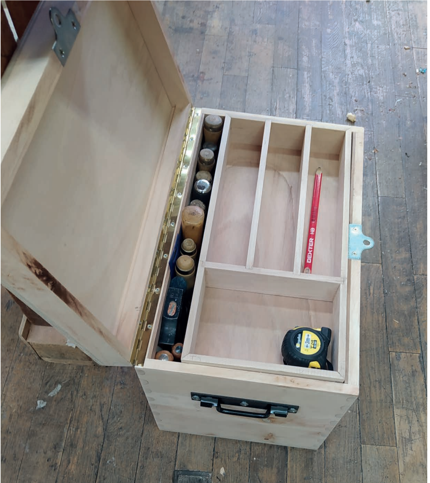
Caisse à outils réalisée avec assemblage en queues d'arrondes faites à la machine.
