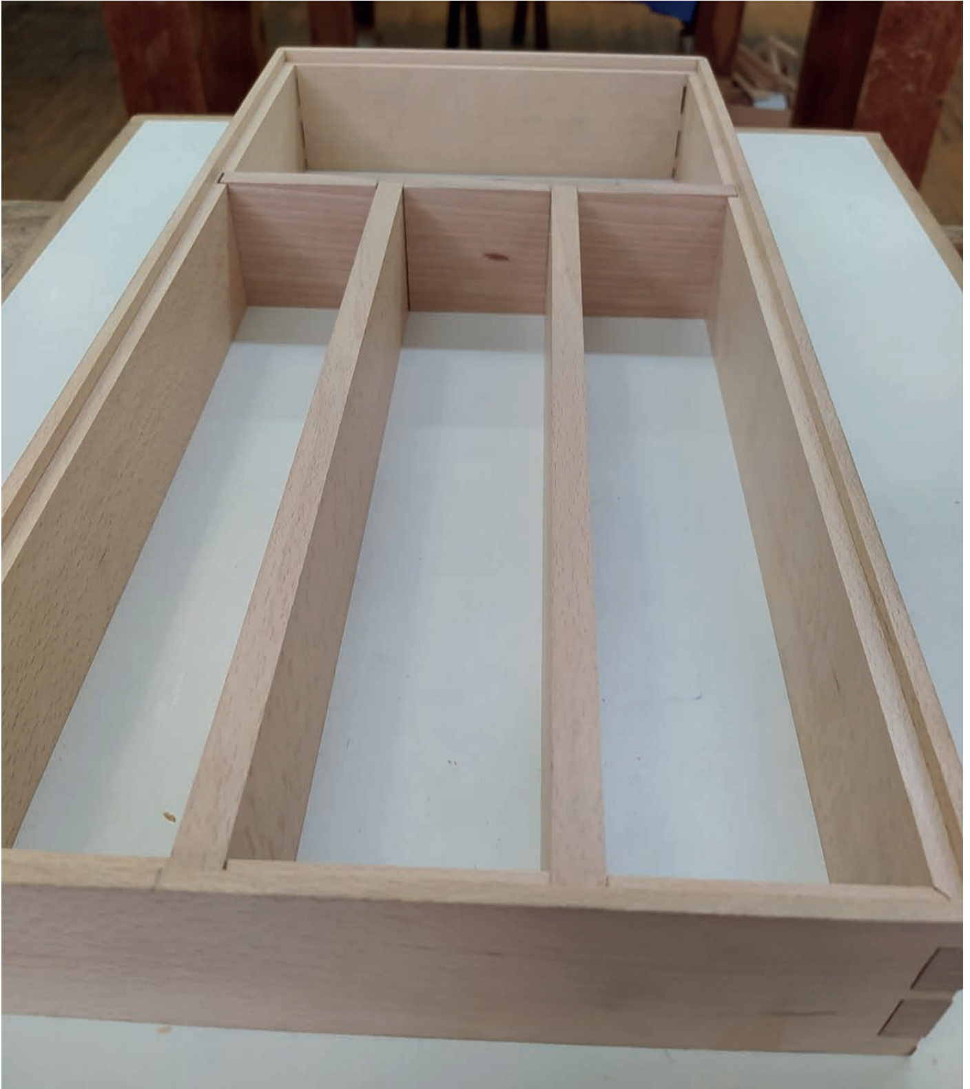
Casier de la caisse à outils réalisée avec des queues d'arrondes faites à la main.
